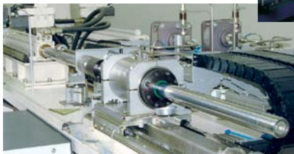
用于液压活塞杆密封件的耐久性测试装置 - 测量密封件或密封系统的摩擦、泄漏和磨损情况。
